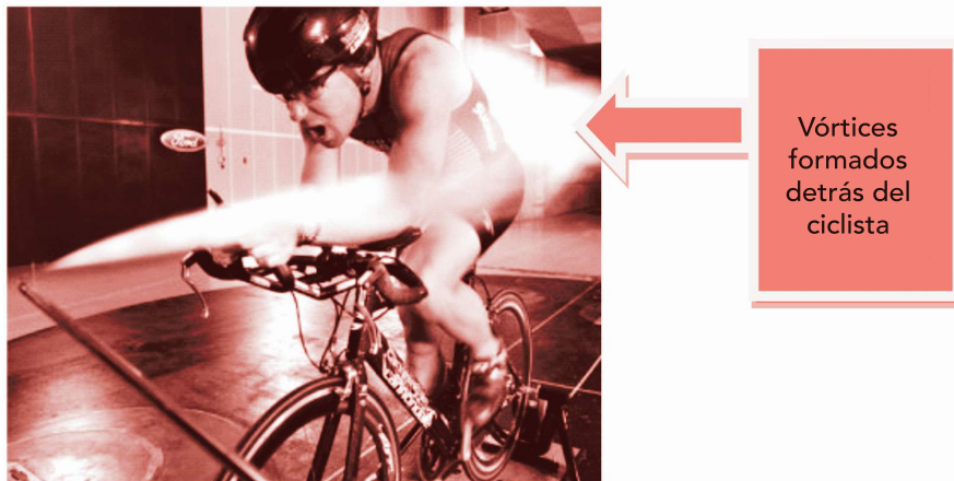
Figura 7. Humo rodeando al ciclista en un túnel de viento formando vórtices en su espalda (amigos del ciclismo).
